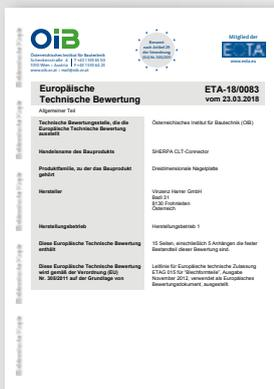
„Der SHERPA CLT-Verbinder - der einzige Systemverbinder im Brettsperrholz-Bereich - verfügt nun über eine Bewertung ETA-18/0083. Die ETA-Bewertung ist ein allgemein anerkannter Nachweis zur technischen Brauchbarkeit eines Bauproduktes, im Sinne der Bauproduktenverordnung. Mit dem ersten standardisierten Verbinder für BSP-Platten bzw. Holzriegelwände wird die Montage und Anwendung in Holzbau maßgeblich erleichtert.“
