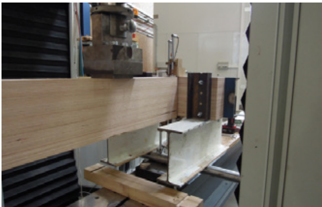
Images en haut : Montage d'essai au Lignum Test Center de la TU Graz avec du bois feuillu.
